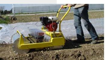
Diese Sämaschinen sind perfekt für die Aussaat von Rettich, Rucola und Sprossen mit 60, 90 und 120 cm Saatbeetbreite (6 bis 12 einfache oder doppelte Reihen oder Breitsaat) und 7,5 cm Mindestabstand zwischen den Elementen.
