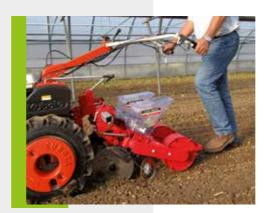
Je nach Ihrer Bedarfslage kann sie sowohl an einen Traktor als auch an einen Einachsschlepper oder einen Minitraktor angehängt werden.
