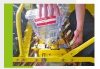
Die Arbeitsweise der Sämaschinen für kleinkörniges Saatgut beruht auf einem abnehmbaren Saatbehälter, in dem sich eine Säwalze befindet.
